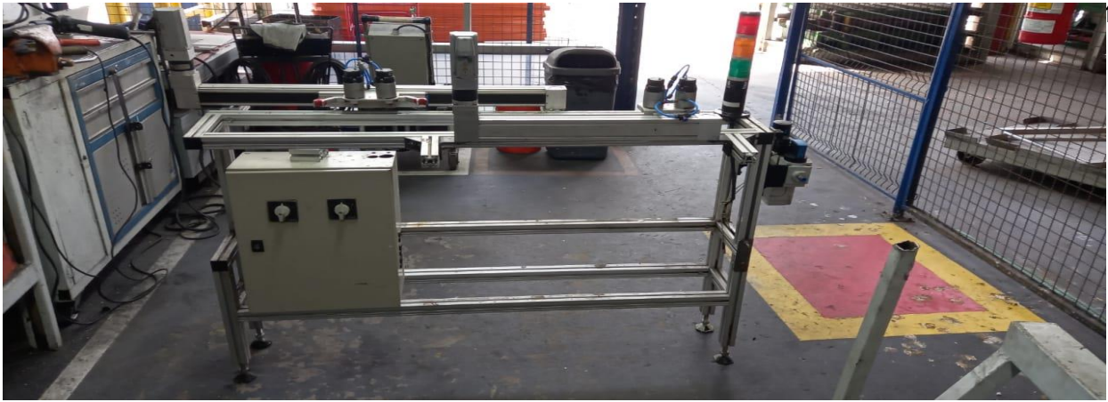
Figura 10. Estrutura Mecânica da Linha
