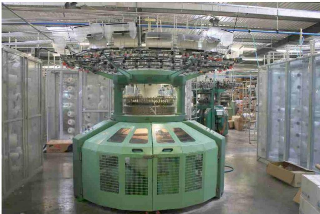
Figura 2 Tear dupla frontura Pilotelli
