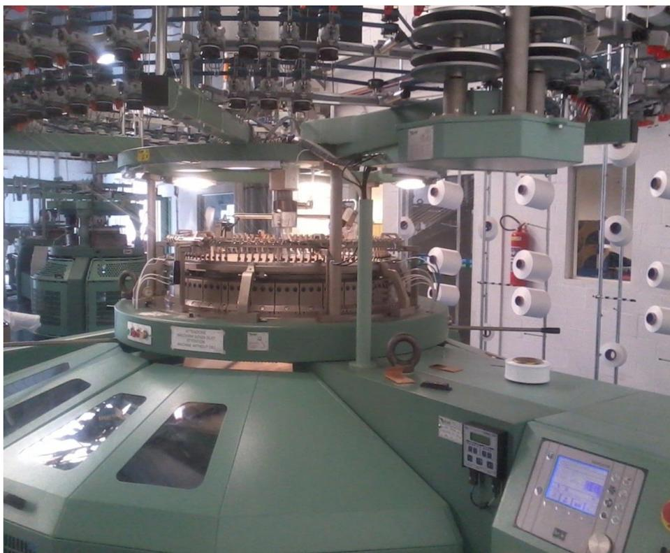
Figura 1: Tear mono frontura Pilotelli
