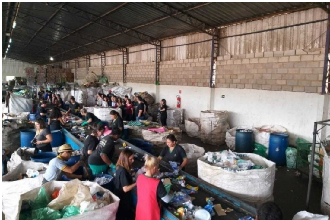
Figura 25. Esteira de separação de materiais
