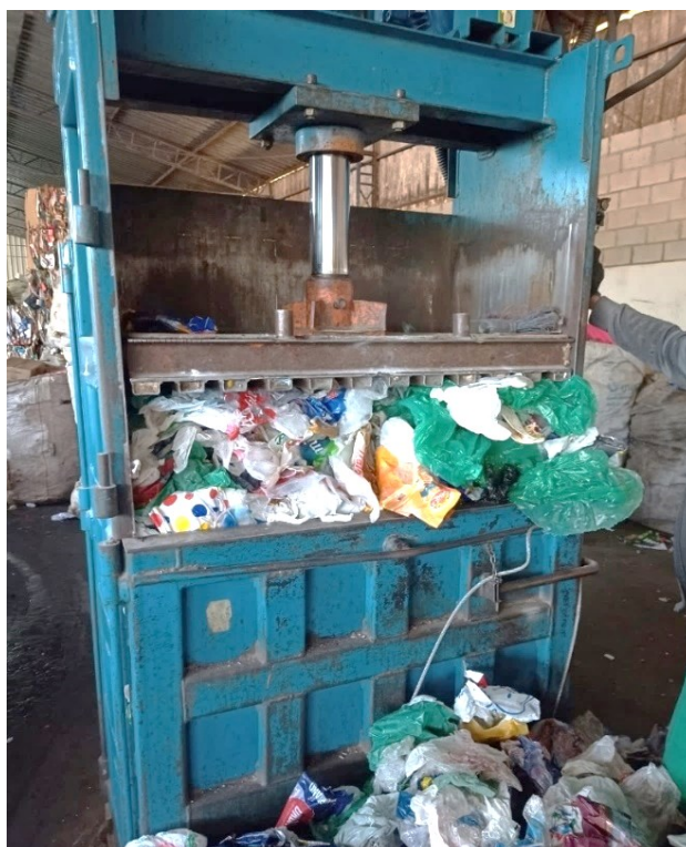
Figura 28. Prensa hidráulica de compactação de materiais
