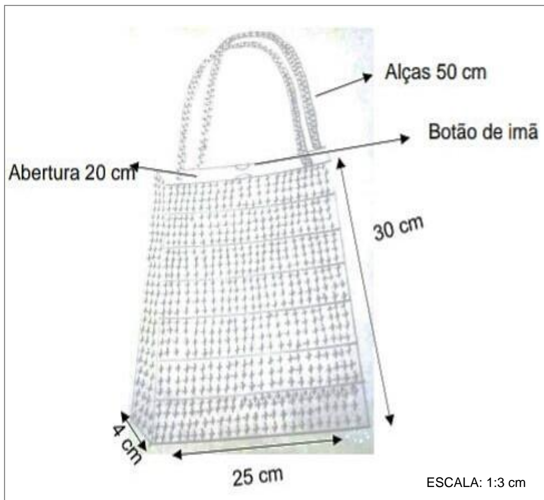
Figura 11 – Desenho técnico da bolsa média.
