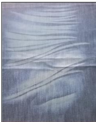
Figura 32 - Aplicação do laser em tecido cru - Fonte: Arquivo pessoal da autora 2014
