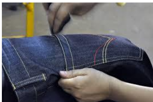
Figura 27 - Lixado manual – Fonte: www.comunidade moda.com.br
