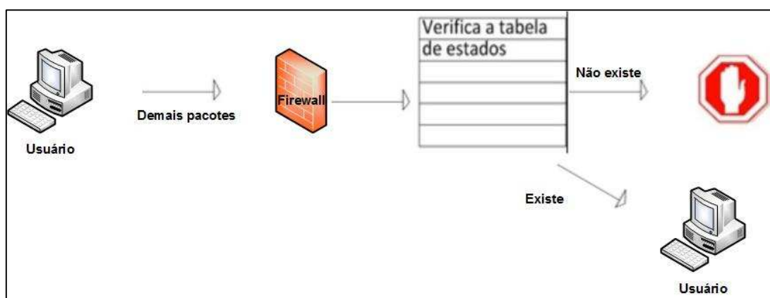
Figura 8: Filtro de pacotes baseado em estados trabalhando na chegada dos demais pacotes Fonte: Adaptado de NAKAMURA e GEUS (2007)
