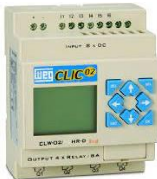
FIGURA 3 – Controlador Lógico Programável – CLP.
