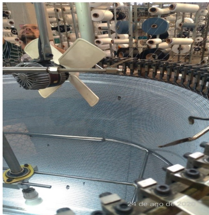
Figura 7 - Defeitos de buracos em malha
