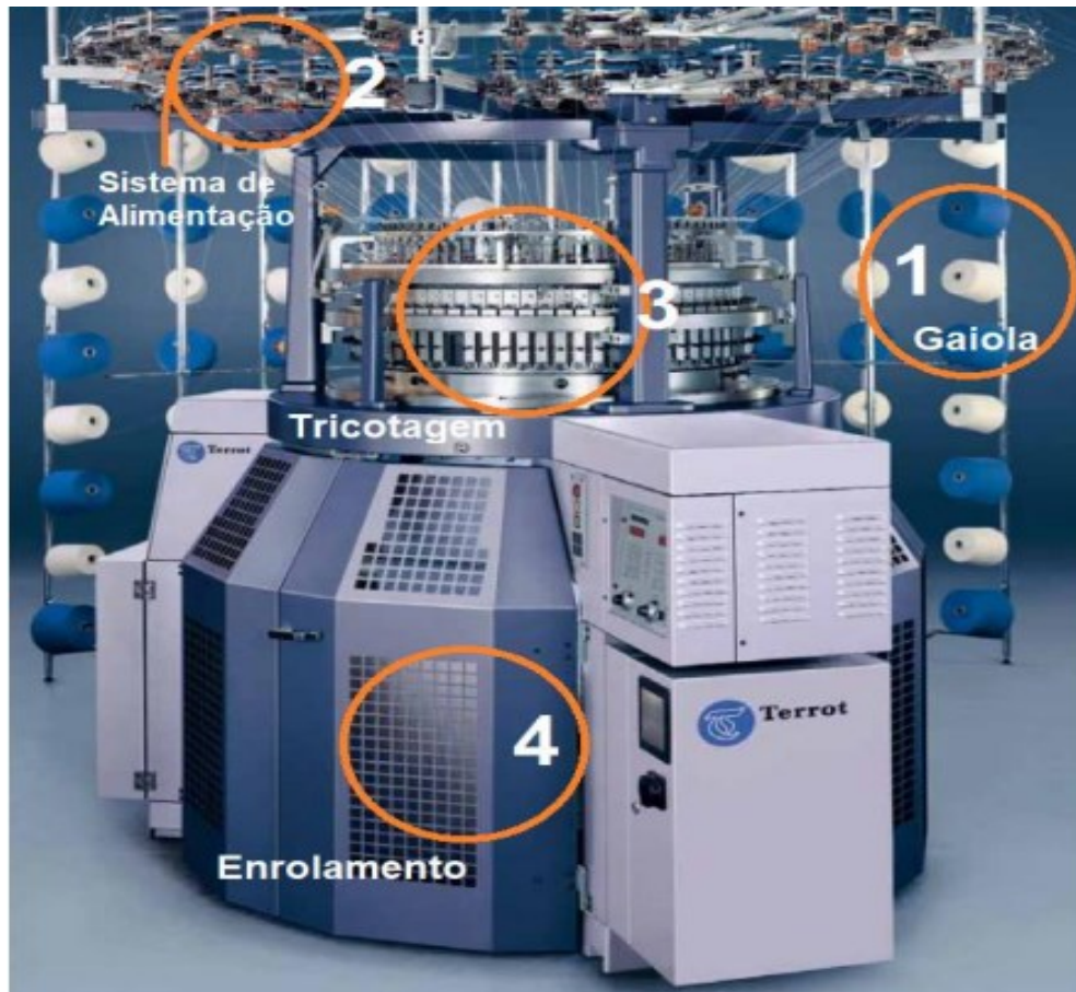
Figura 2 - Principais partes do tear circular
