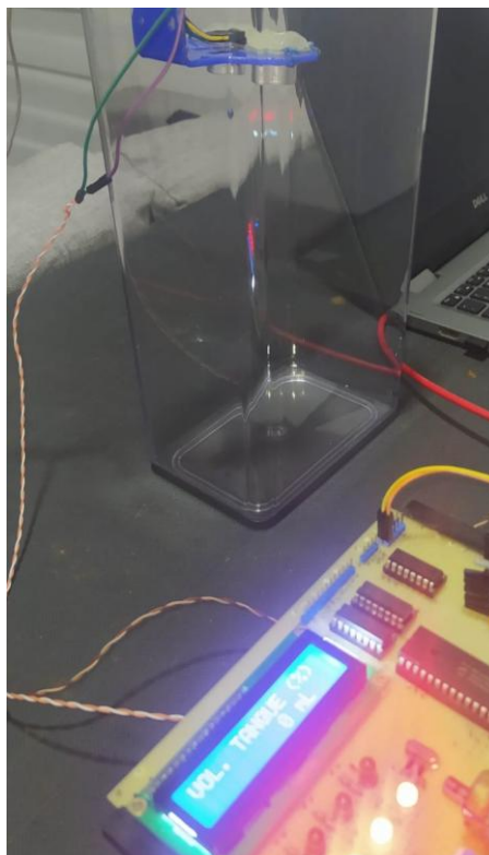
Figura 40 – Sensor medindo volume zero de água com reservatório vazio
