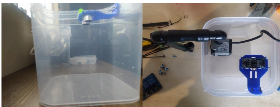
Figura 43–Instalação do sensor ultrassônico para leitura de volume de água do reservatório
