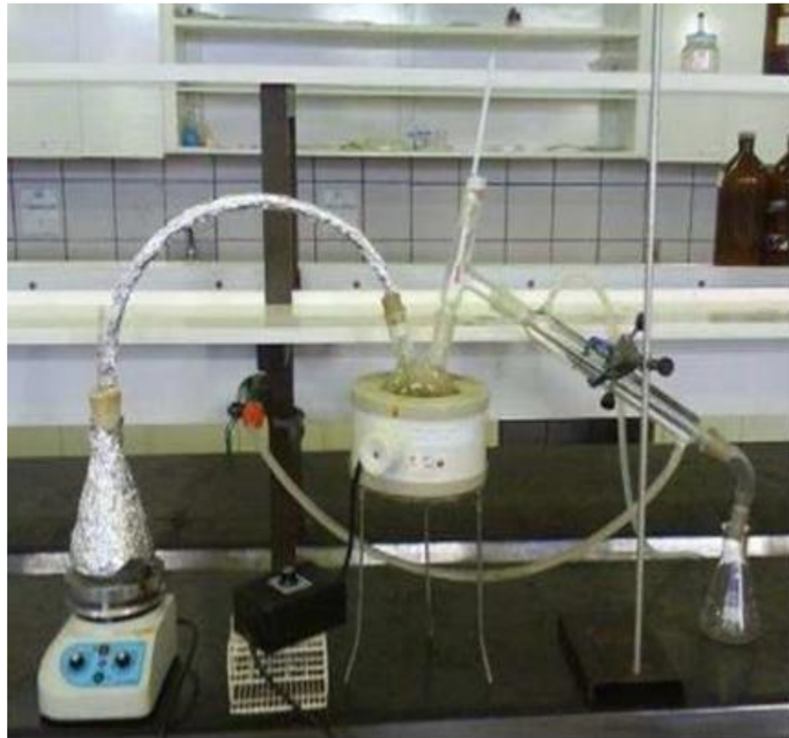
Figura 2: Aparelho de destilação de Óleo Essencial da Lavanda (Fonte: < http://www.ebah.com.br > Acesso: março de 2022)
